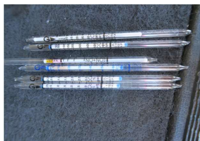
噴出孔の気体成分、濃度を計測する。
