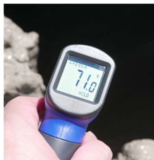
噴出孔内部や、表面、土の内部等の温度を計測する。
